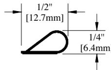
CF-12: Peut être utilisé sur des portes en métal classées 3 heures; des portes en composite recouvertes de bois classées 1-1/2 heures et des portes en bois classées 20 minutes. Disponible en noir et translucide.
